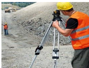
Сурет 1. - Геодезиялық құрылғы нивелир
